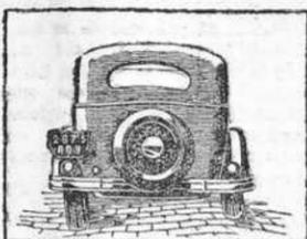
Chassis Renault indeformable, descansando sobre tres puntos de apoyo. Confort máximo en los asientos por una balasta transversal articulada. Supresión del balanceo por la libertad de oscilación del eje trasero y por amortiguadores hidráulicos a doble efecto. Ninguna complicación ni piezas frágiles en el chassis. Dirección ultra-precisa.
