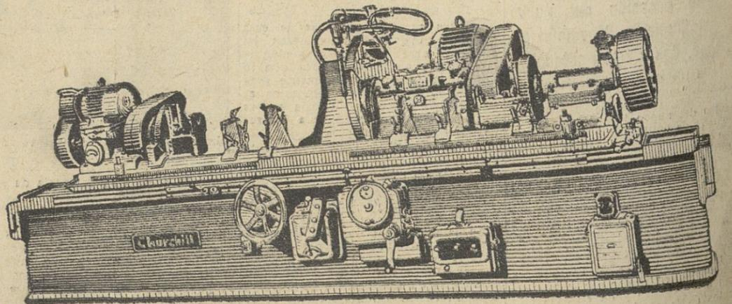
Maquinaria moderna y de precisión para rectificar y bruñir toda clase de cilindros y cigüeñales de motores terrestres, marinos y de aviación
