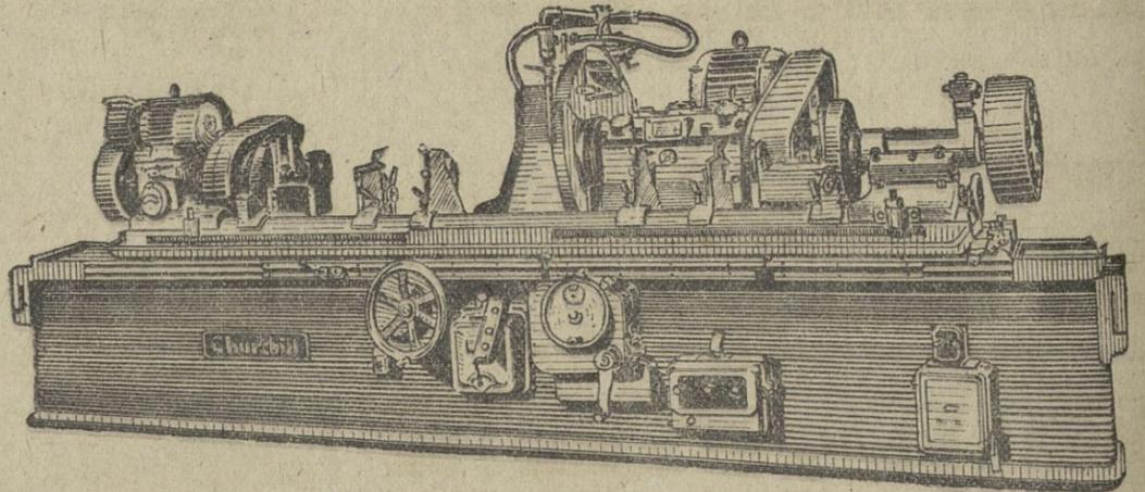
Maquinaria moderna y de precisión para rectificar y bruñir toda clase de cilindros y cigüeñales de motores terrestres, marinos y de aviación
