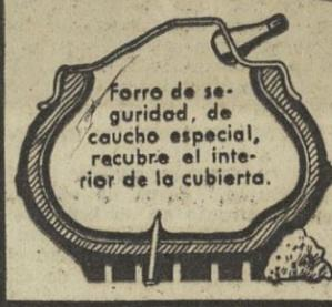
Forro de seguridad, de caucho especial, recubre el interior de la cubierta.
