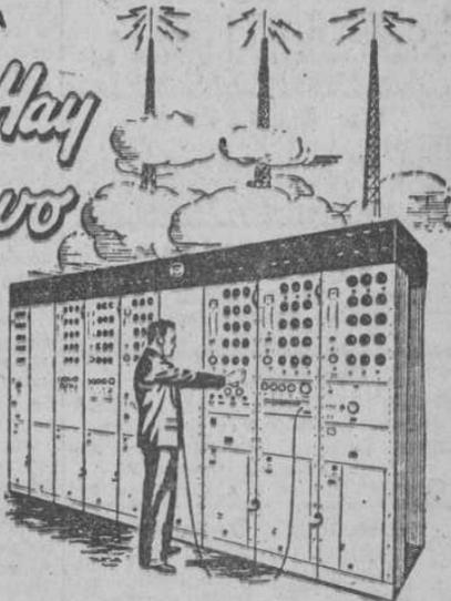
El sueño del perito de radio. El receptor de tipo «Diversity» de ondas cortas construido por la RCA, es el más perfecto en el campo de las comunicaciones. Reproduce tres copias diferentes de la misma transmisión en tres antenas diferentes y automáticamente selecciona la mejor. Este mismo técnico de la RCA, que ahora está dedicado a la causa de las Naciones Unidas, nos promete una radio superior para los días de paz.
