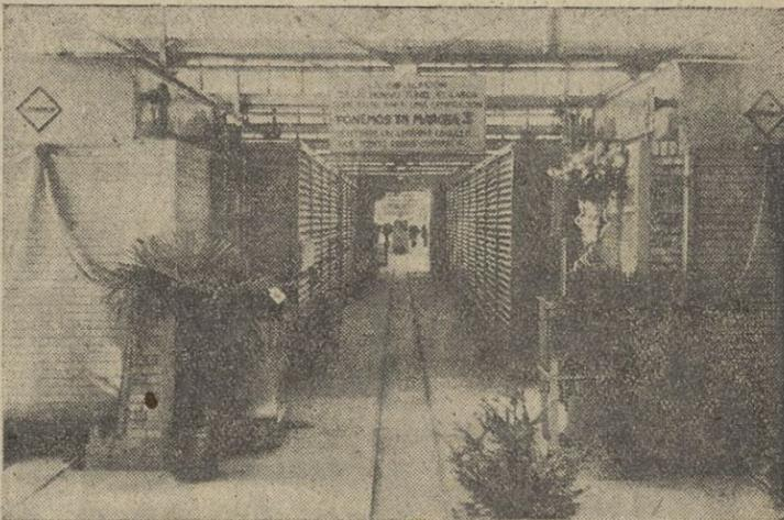
Vista de frente de dos de los hornos-túnel continuos. La leyenda dice: "La instalación de un horno-túnel es labor suficiente para una generación. Ponemos en marcha tres. Sentimos un legítimo orgullo que todos debéis compartir"
