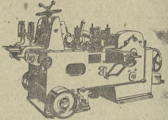
**CARACTERISTICAS:** 5 ejes portacuchillas montados sobre rodamientos de bolas. 3 velocidades de alimentación. Escuadría máxima 23 por 8 cm. Potencia necesaria de 15 a 25 caballos, según escuadrías. Paso neto total con su transmisión: 2.650 kilos.
