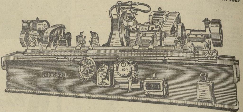
Maquinaria moderna y de precisión para rectificar y bruñir toda clase de cilindros y cigüeñales de motores terrestres, marinos y de aviación
