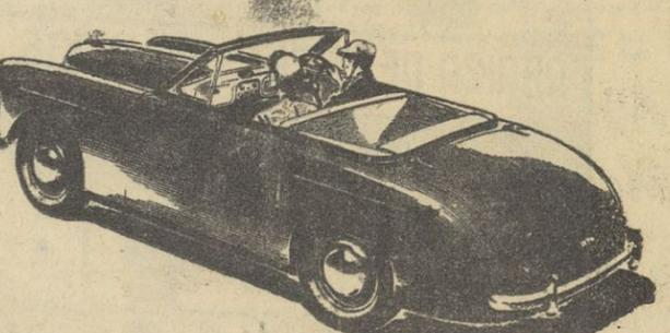
El rendimiento de este nuevo Austin es el de un turismo de deporte con el placer que siempre proporciona un automóvil convertible. Tiene un poderoso motor de 46 b. h. p. con dos carburadores y válvulas en cabeza, potentes frenos hidráulicos y suspensión frontal independiente. La capota se acciona con facilidad en unos momentos.
