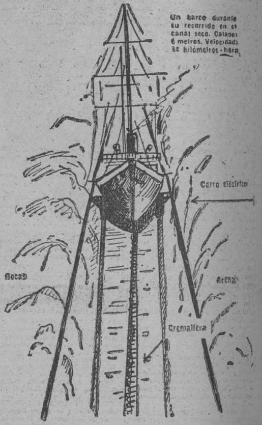
Este dibujo da una idea del paso en seco de un barco por el canal sin agua de Akaba. El barco sería colocado sobre un carro deslizante y tirado por una fuerza motriz
