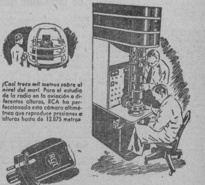
¡Casi trece mil metros sobre el nivel del mar! Para el estudio de la radio en la aviación a diferentes alturas, RCA ha perfeccionado esta cámara altimétrica que reproduce presiones a alturas hasta de 12.875 metros
