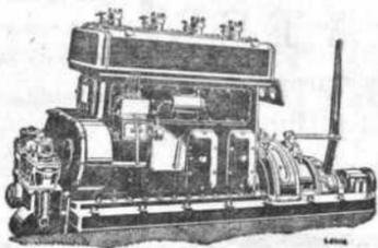
Puesta en marcha a mano.-- Arranque en frío sin cartuchos explosivos, ignición eléctrica en lámparas
