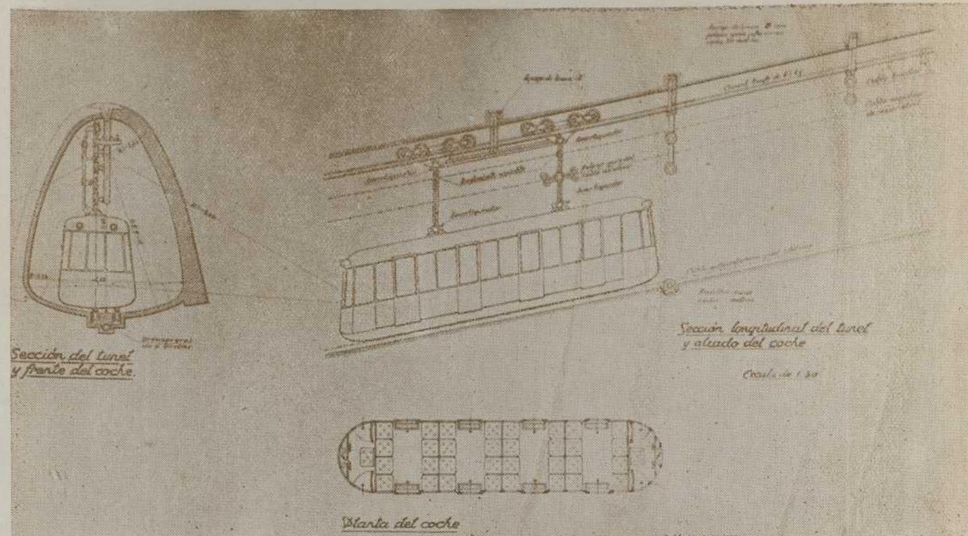
A la izquierda: Sección del túnel y frente del coche funicular. A la derecha: sección longitudinal del túnel y alzado del coche. Abajo: planta del vehículo
