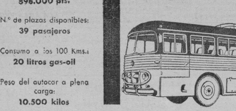
AUTOCAR CON MOTOR DE 120 CV. CARROCERIA METALICA
