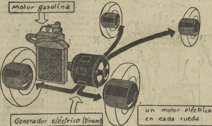
Así funciona el tipo de auto "Simétrico": Un motor de gasolina que pone en movimiento una dinamo. Esta engendra energía eléctrica y la transmite a las cuatro ruedas. Cada rueda dispone de un motor eléctrico de 4 cv. Basta con un botón para acelerar, frenar y parar las cuatro ruedas a la vez. Como un "jeep" pero sin engranajes ni cambios de velocidad.
