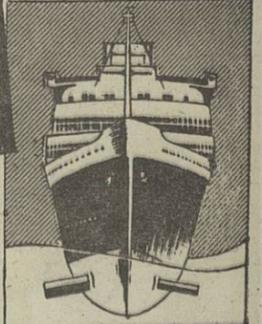
El objeto del "estabilizador" es lograr que, con el mar en malas condiciones, el movimiento del buque quede reducido a un mínimo. Consiste en dos aletas de forma parecida a las alas de un avión, colocadas a cada costado del buque bajo la línea de flotación y controladas automáticamente por giróscopos, que determinan el momento en que las aletas tienen que actuar y la inclinación necesaria para contrarrestar el balanceo que produciría el oleaje.
