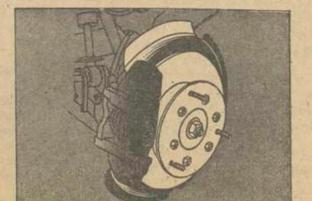
Frenos de disco en ruedas delanteras y de tambor en traseras.
