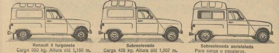
Renault 4 furgoneta Carga 350 kg. Altura útil 1,150 m.
