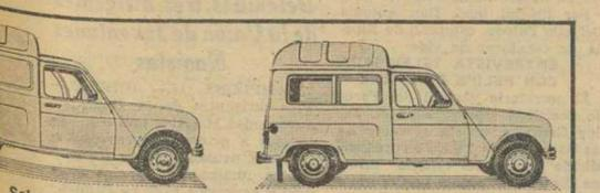
Sobreelevada 425 kg. Altura útil 1,307 m. Volumen útil de carga 2,08 m<sup>3</sup>
