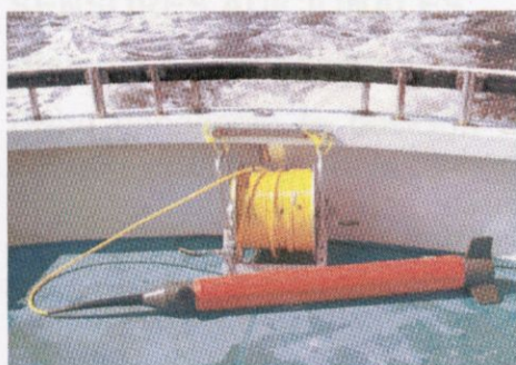
Vehículo y cable de arrastre.
