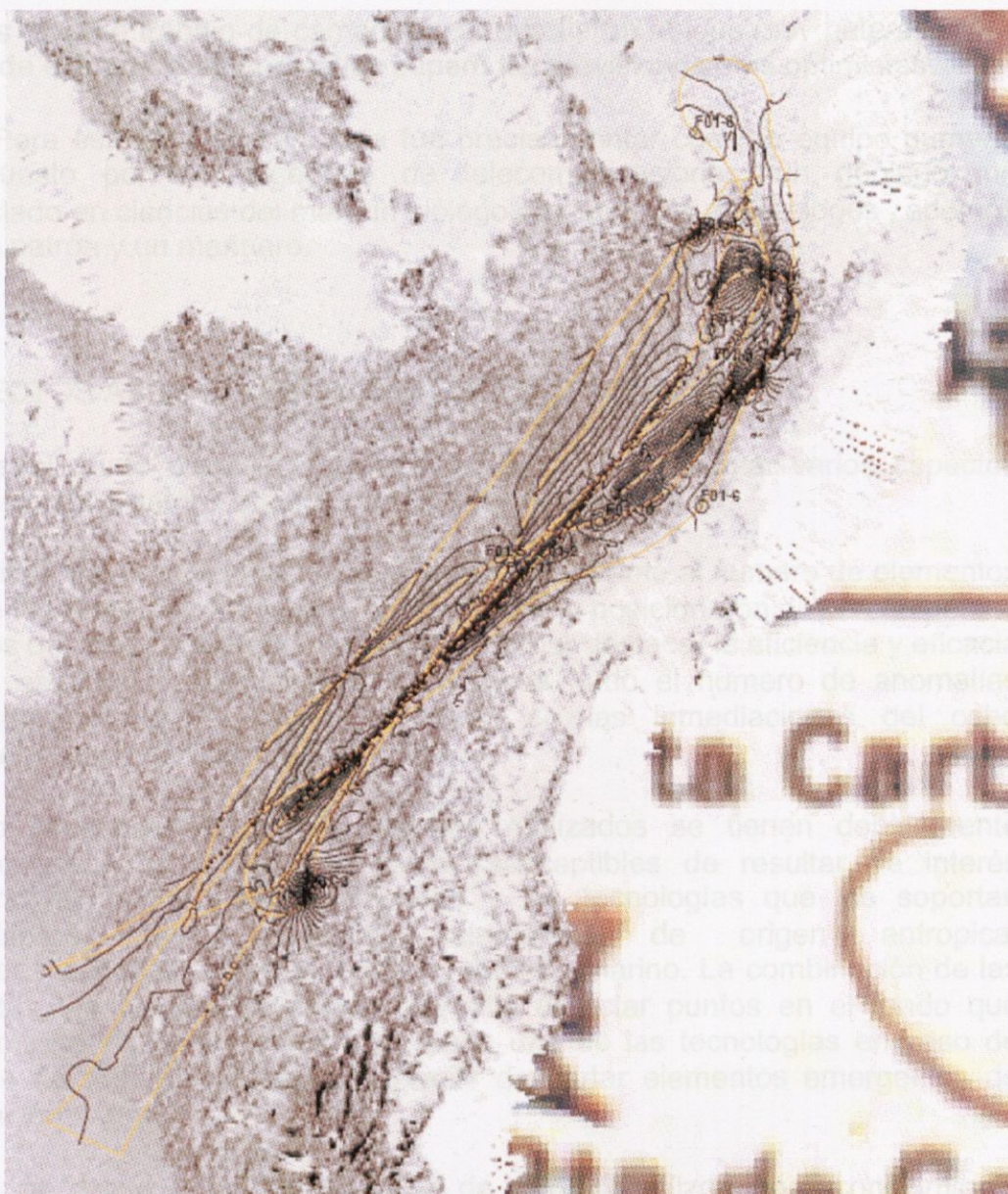
Curvado obtenido con los datos del magnetómetro superpuesto sobre el registro sonar.
