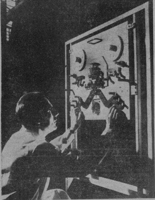
En Gran Bretaña se hace uso creciente de máquinas computadoras para calcular datos y para controlar maquinaria. Aquí un técnico, comprueba el mecanismo de control de un "lector" de cinta de papel de una de ellas.
