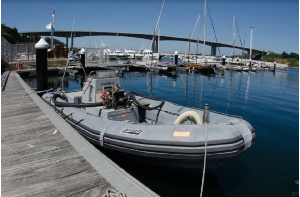
Ilustración 15. Neumática semirrígida de la Armada Española empleada como soporte de los trabajos de sondaxe. Se aprecia la motobomba de dos cilindros montada en la consola que abastecía dos mangas de succión.
